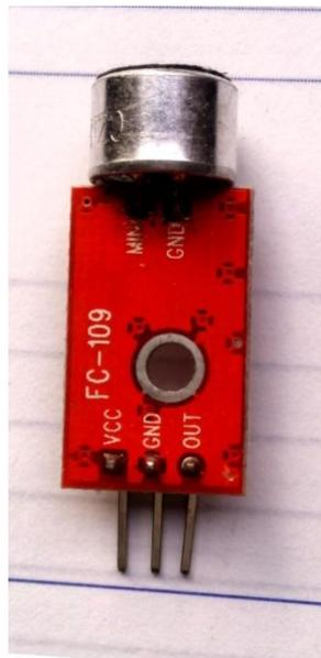
Questo e' un microfono sostanzialmente diverso dal precedente. La circuiteria presente sulla basetta non si riduce ad un semplice comparatore ma propone un vero amplificatore, in grado di produrre in output una tensione proporzionale al volume del rumore percepito.
