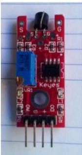
Il sensore tattile è un transistor (o almeno è un sensore che ha la forma di un transistor) la cui gamba centrale è ripiegata su di esso. La gamba centrale è in realtà un'antenna in grado di percepire, al semplice contatto, le onde elettromagnetiche emesse dal corpo umano.
