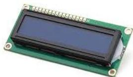
Il display 1602 e' una versatile interfaccia di output sulla quale possono essere visualizzati messaggi di due righe da 16 caratteri. Il modulo e' facilmente gestibile attraverso il controller Hitachi HD44780, emulato da Arduino tramite uno specifico software presente nelle sue librerie.
