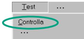
Nei linguaggi di programmazione grafici KOP / FUP è possibile seguire l'andamento del risultato del test dal cambiamento di colore nel segmento programmato. Il cambiamento di colore sta ad indicare che il risultato logico combinatorio è fino a questo punto soddisfatto.
