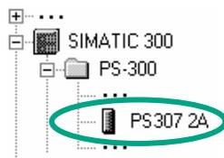
E' necessario inserire prima di tutto un alimentatore. Navigando nel catalogo, posizionarsi su **PS307 2A** ed inserire l'alimentatore sul posto connettore 1 mediante Drag & Drop.
