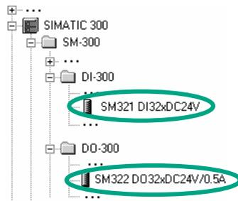
Inserire analogamente le unità di ingresso/uscita **DI32xDC24V** e **DO32xDC24V/0.5A** sui posti connettore 4 e 5.
