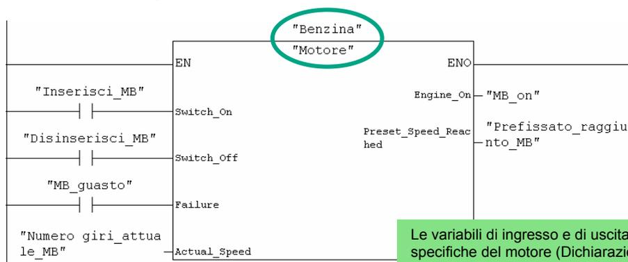
Le variabili di ingresso e di uscita specifiche del motore (Dichiarazione "in" e "out") vengono visualizzate nell'FB "Motore".
