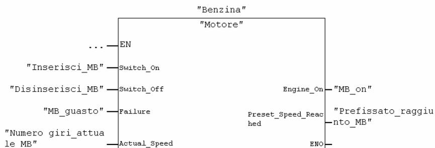
A ogni variabile viene assegnato un segnale "MB\_xxx" per il motore a benzina.
