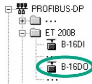
Trascinare analogamente l'unità **B-16DO** sul sistema master.
