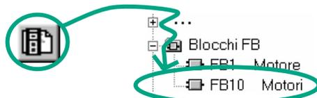
Alla fine dell'OB1 inserire un nuovo segmento e completarlo con il richiamo dell'**FB10** ("Motori").
