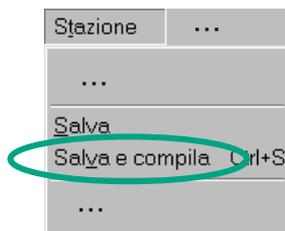
Mediante **Salva e compila** i dati vengono preparati per il trasferimento nella CPU.
