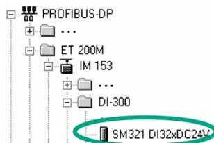
L'ET 200M può accogliere altre unità di ingresso/uscita. Selezionare per esempio l'unità **DI32xDC24V** per il posto connettore 4 ed inserire l'unità con doppio clic.
