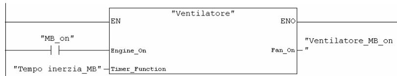
Programmare nel segmento 7 il richiamo della funzione FC1 con gli operandi del motore diesel. Procedere come per il segmento precedente (gli operandi per il motore diesel sono già stati acquisiti nella tabella dei simboli).
