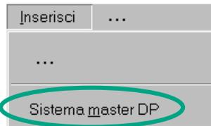
Selezionare un **sistema master DP** ed inserire il master DP sul posto connettore 2.1.
