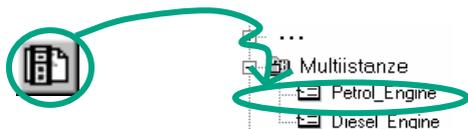
Inserire il richiamo "Motore a benzina" come blocco di multiistanza "Motore a benzina" nel segmento 1.
