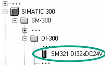
Per un'unità di ingresso (DI, Digital Input) navigare a **SM321 DI32xDC24V** ed inserirla sul posto connettore 4. Il posto connettore 3 rimane libero.
