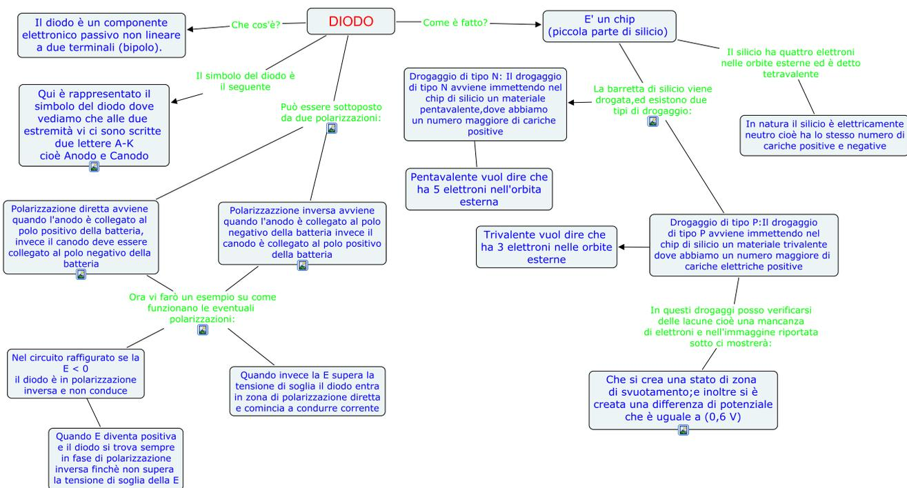
Il diodo è un componente elettronico passivo non lineare a due terminali (bipolo).
